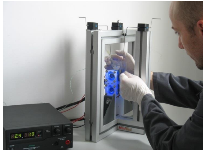
Rico Belitz bestückt den Versuchsaufbau mit einem Mikroreaktor. Mit dem Aufbau lässt sich die pyroelektrische Wasserstoffherzeugung an Kristallen nachweisen. Bild: Fraunhofer THM
